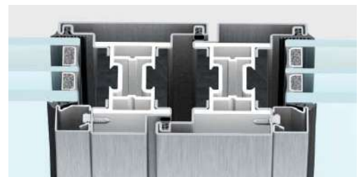
nodo centrale | sezione in vista 156 mm
