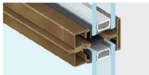
traverso dividi vetro | sezione in vista 36 mm
