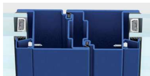
nodo centrale | sezione in vista 151 mm
