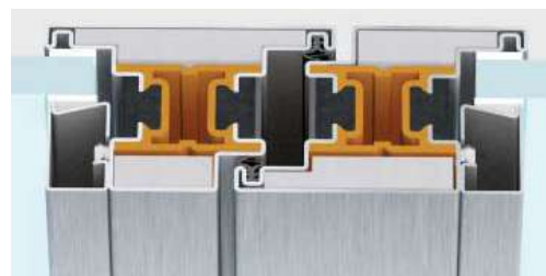
nodo centrale | sezione in vista 156 mm
