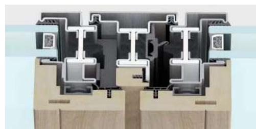
nodo centrale | sezione in vista 145 mm
