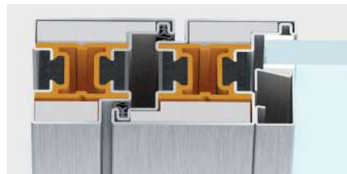
nodo laterale | sezione in vista 134 mm
