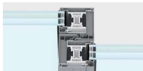
nodo centrale standard | sezione in vista 94 mm
