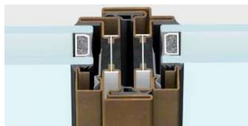
nodo centrale | sezione in vista 62 mm
