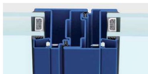
nodo centrale | complanare | sezione in vista 101 mm
