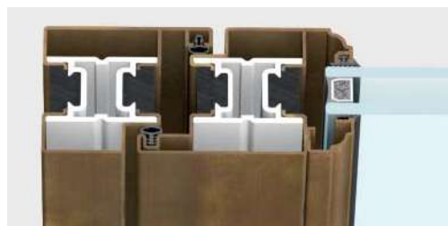
nodo laterale | sezione in vista 132 mm
