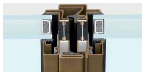
nodo centrale | sezione in vista 62 mm
