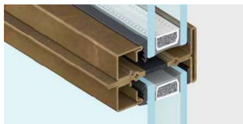
traverso dividi vetro | sezione in vista 36 mm
