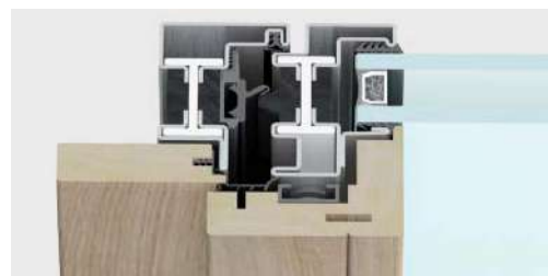
nodo laterale | sezione in vista 85 mm
