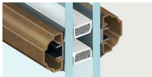
dividivetro | sezione in vista 31 mm
