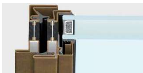
nodo laterale | sezione in vista 47 mm
